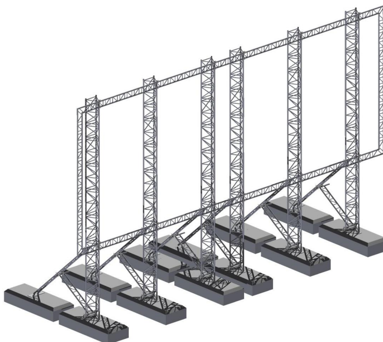
Konstrukcja 14,35 x 5,25m
