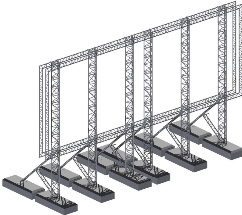
Konstrukcja 14,35x5,25m dwustronna
